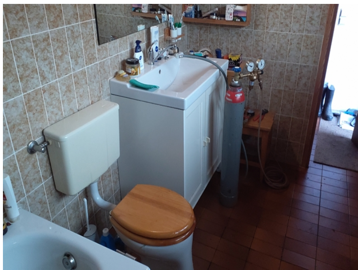
Tracergas Untersuchung der Wasserleitungen
